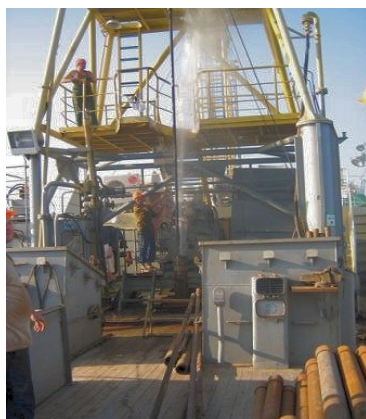
Рис. 3. Выброс водяной пульпы с метаном
