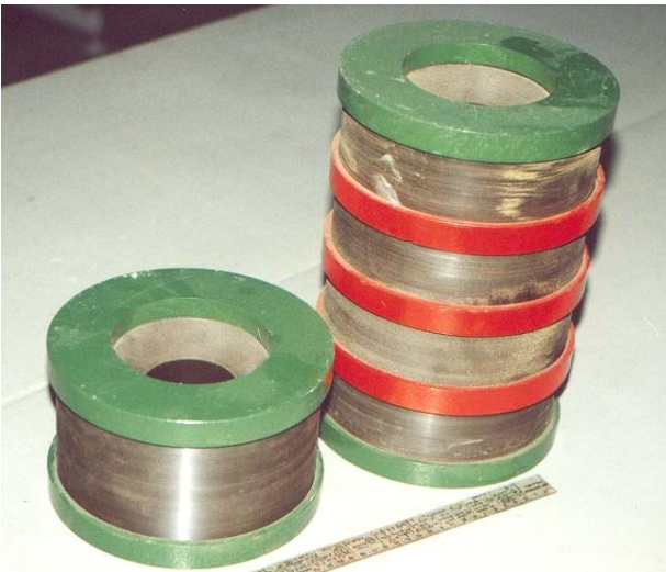
Рис. 1.3. Амортизаторы роликов рольгангов с полиуретановыми УЭ сжатия
