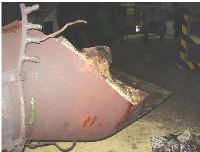
Рис. 1. Разрушенный соединительный шпиндель толстолистового стана 3000
