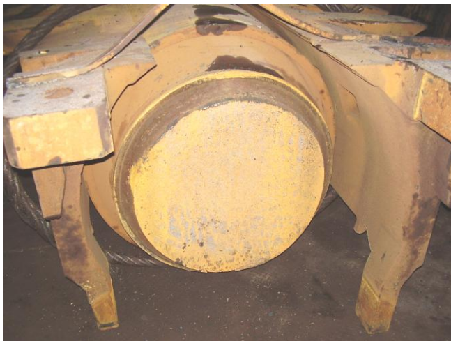
Рис. 2. Разрушенный рабочий валок толстолистового стана 3000
