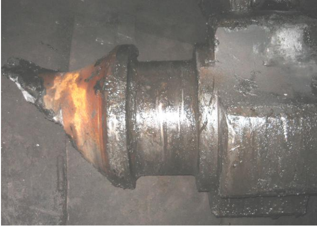
Рис. 3. «Косая» поломка брехшпинделя
