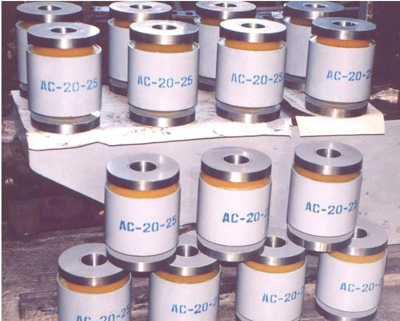
Рис. 6.3. Амортизаторы сдвига для станинных роликов слябинга-1150 ОАО «ММК им. Ильича»
