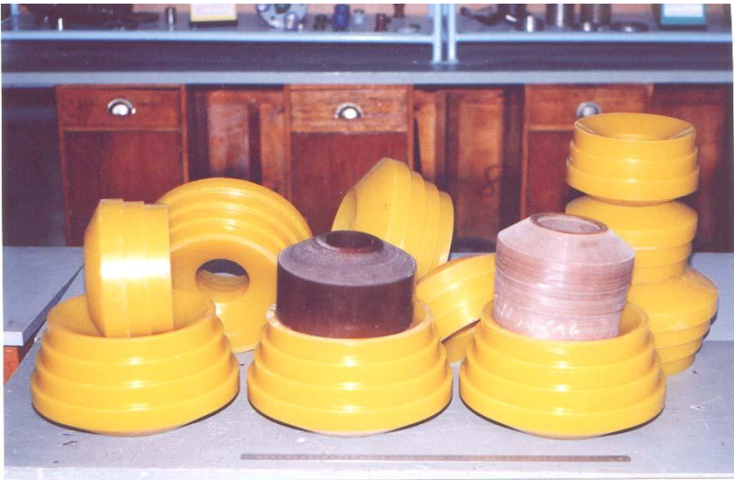
Рис. 6.4. Упругие элементы амортизаторов сдвига
