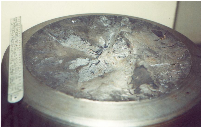
Рис. 4. «Прямой» излом брехшпинделя
