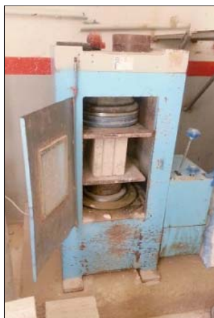
Рис. 2. Испытание на сжатие
